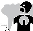
Beim Plasmuschneiden entstehen Rauchgase bzw. toxische Dämpfe, die zu Sauerstoffmangel in der Atemluft führen können. Sorgen Sie daher immer für ausreichend Frischluft, technische Belüftung (oder ein zugelassenes Atmungsgerät). Verwenden Sie die Schneidanlagen nur in gut belüfteten Hallen, im Freien oder in geschlossenen Räumen mit ausreichend starker Absaugung, die den aktuellen Sicherheitsstandards entspricht.
