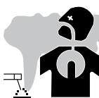
Выделяемые при сварке дым, газ и пыль опасны для здоровья. Вентиляция должна быть достаточной, и может потребоваться дополнительная подача воздуха.
