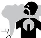
Les fumées, gaz et poussières émis par le soudage sont dangereux pour la santé. Il faut prévoir une ventilation suffisante et un apport d'air est parfois nécessaire. Un masque à air frais peut être une solution en cas d'aération insuffisante.
