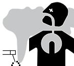
I fumi, gas e polveri emesse dalla saldatura sono pericolosi per la salute. È necessario prevedere una ventilazione sufficiente e un apporto d'aria potrebbe avverarsi necessario. Una maschera ad aria fresca potrebbe essere una soluzione in caso di aerazione insufficiente. Verificare che l'aspirazione sia efficace controllandola in relazione alle norme di sicurezza.
