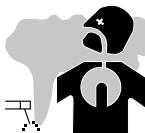
Dampen, gassen en stof uitgestoten bij het lassen zijn gevaarlijk voor de gezondheid. Zorg voor goede ventilatie en verse lucht tijdens het lassen. Een lashelm met frisse lucht aanvoer kan een oplossing zijn als er onvoldoende ventilatie is. Controleer of de zuigkracht efficiënt is, en verifieer of deze aan de gerelateerde veiligheidsnormen voldoet.
