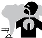
El humo, el gas y el polvo que se emite durante la soldadura son peligrosos para la salud. Hay que prever una ventilación suficiente y en ocasiones puede ser necesario un aporte de aire. Una máscara de aire puede ser una solución en caso de aireación insuficiente. Compruebe que la aspiración es eficaz controlándola conforme a las normas de seguridad.
