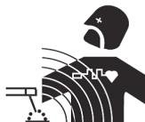
Les courants électriques traversant un conducteur causent les champs électriques et magnétiques (EMF).
